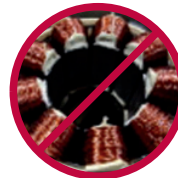
Плавлення внутрішнього ізолятора
